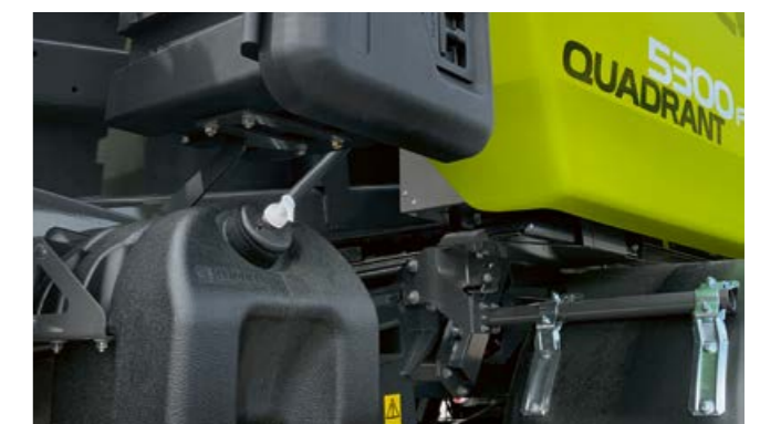
ถังน้ำมันขนาดใหญ่ (18 ลิตร) พร้อมชุดจ่ายสปูในตัว
