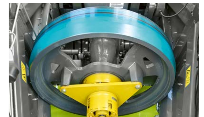
ล้อช่วยแรงรุ่นใหม่: น้ำหนักและแรงเฉื่อยเพิ่มขึ้นเพื่อรับมือกับแรงกระทัดรัดกว่าเดิม
