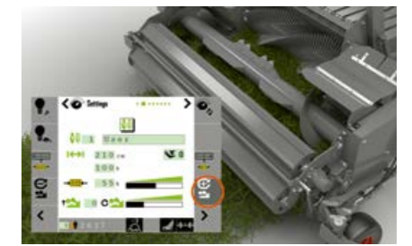
ระบบ POWER FEEDING SYSTEM ที่ย้อนการทำงานได้อย่างง่ายดายจากห้องคนขับ
