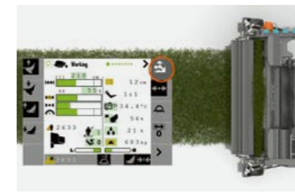
ระบบป้อนไฮดรอลิก PFS ปรับตั้งง่ายจากที่นั่งแทรกเตอร์
